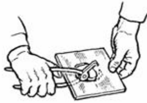
Рис. 13. Расширение отверстия кусачками
