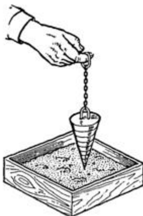
Рис. 15. Проверка пластичности раствора эталонным конусом
