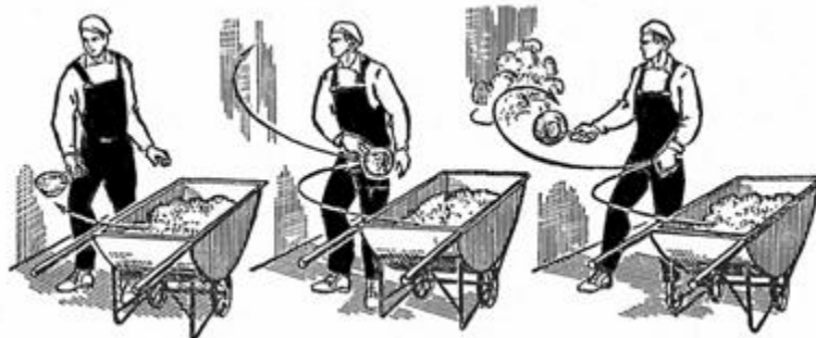
Рис. 92. Приемы нанесения раствора отделочным ковшом
