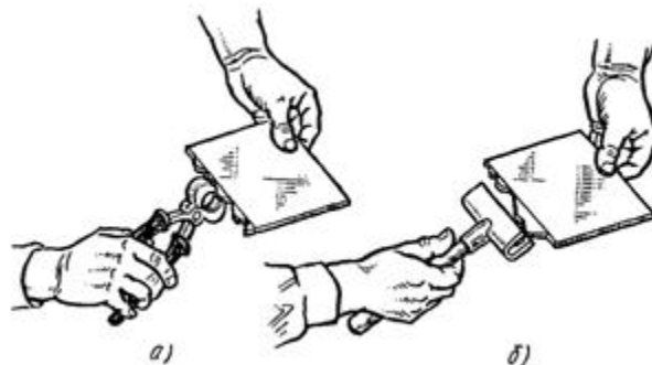
Рис. 4. Устранение местных искривлений на кромках плиток с помощью кусачек (а) или захватного приспособления - плитколома (б)
