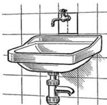
Рис. 110. Замененные плитки у водоразборного крана
