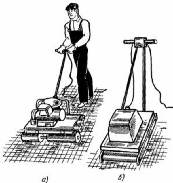
Рис. 35. Втапливание (припрессовывание) свежеложенных плиток виброкатком (а) и виброплита (б)
